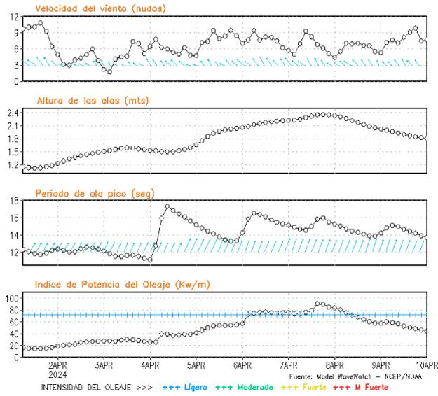
**Figura 8.** Series de tiempo de la velocidad del viento (nudos), altura de olas (m), periodo de la ola (s) e índice de la potencia del oleaje (Kw/m) frente a las costas de Talara, Callao e Ilo, del 01-04-2024 al 08-04-2024 Fuente: Datos: modelo WWATCH III; Grafico: DHN
